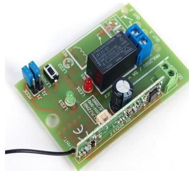
Přijímač spolupracuje s klíčenkami FLAJZAR KV1TX (popř. KV2TX, KV4TX, KV5TX). Může být ovládán až 15-ti klíčenkami, které lze snadným způsobem uložit do paměti přijímače. Vysoký stupeň zabezpečení předurčuje modul pro nasazení zejména v oblastech zabezpečovací techniky (ovládání zabezpečovacích ústředen, otevírání garážových vrat a bran), ale vzhledem k univerzálnosti a výkonovým kontaktům relé je možné modul použít i pro běžné ovládání spotřebičů (umístěním do rozvodné skříně).
