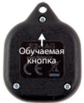
Кнопка расположена на задней части брелока, для ее нажатия используйте канцелярскую скрепку.
